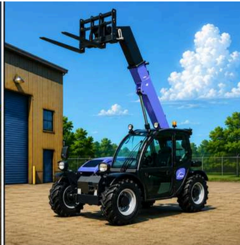
Stapler Diesel Hubhöhe 5.80 m Hubkraft 3`000 kg Höhe 1.94 m Länge 3.79 m Breite 1.81 m Gabellänge 1.04 m Eigengewicht 4`850 kg
