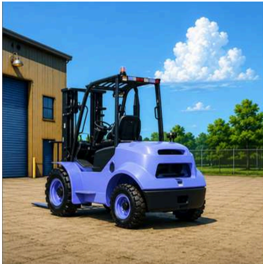
Stapler Diesel 4x4 Hubhöhe 4.70 m Hubkraft 3`500 kg Masthöhe eingefahren 2.58 m Länge 3.25 m Breite 1.77 m Gabellänge 1.20 m Eigengewicht 6`470 kg
